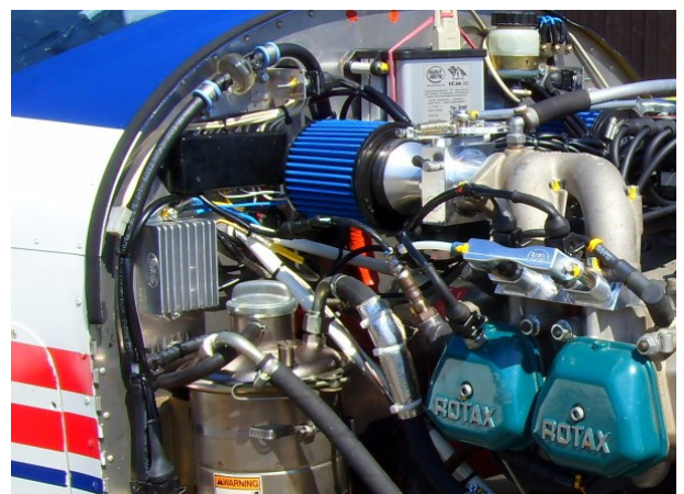
Montage in der Front mit guter Kühlung durch Fahrtwind und max. 70cm Zuleitung zur Batterie
